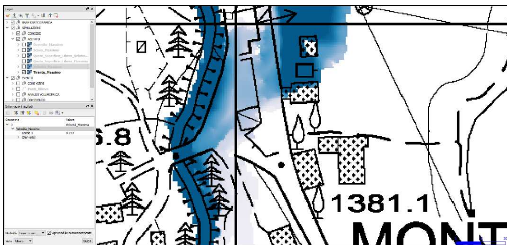
Simulazione tirante massimo – Area di realizzazione della cabina di consegna Studio Università di Trento - DICAM
